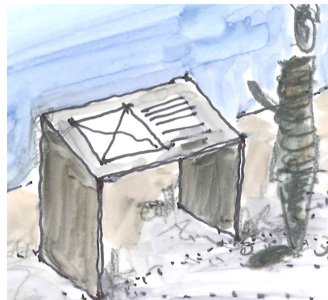
Infopult aus Corten-Flachstahl, d=30mm Höhe ca. 1,2m, geneigte Infobläche
