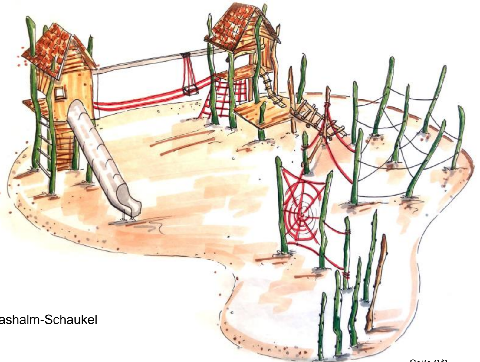
Spielanlage mit zwei Türmen, Tunnelrutsche, Hängebahn, Kletterparcours und Spinnennetz
