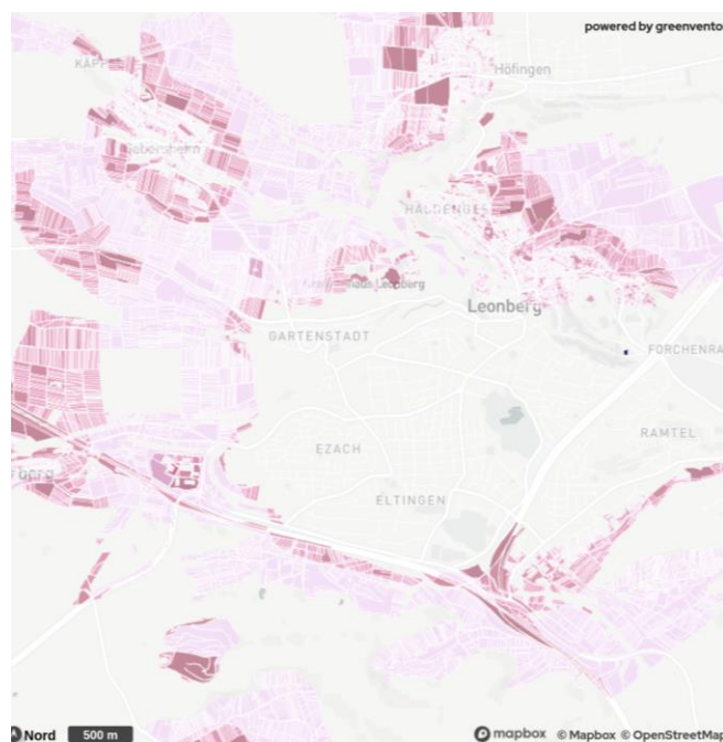
Abbildung 50: Nutzung des Wärmepotenzials der oberen Erdschichten
