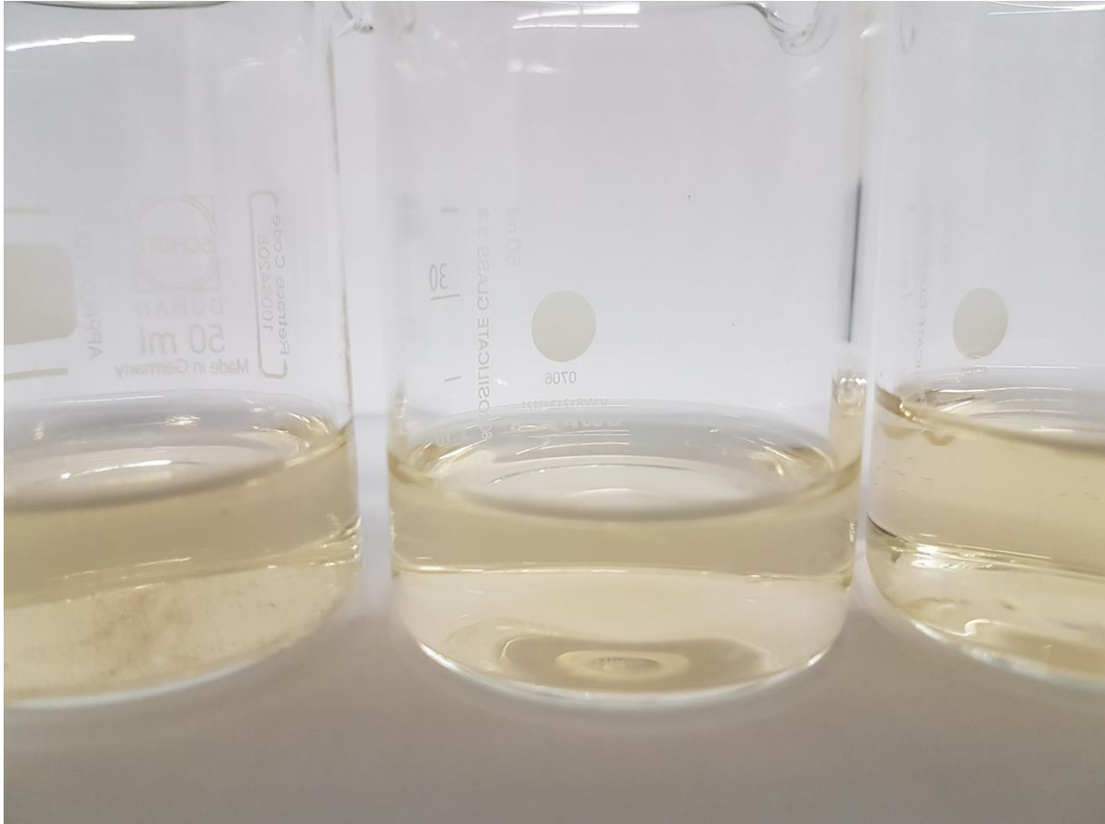
Abbildung 3: Klarwasser, Filtrat aus Faltenfiltration, Filtrat aus Falten- und Membranfiltration (von links nach rechts)
