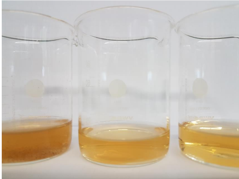
Abbildung 1: Presswasser, Filtrat aus Faltenfiltration, Filtrat aus Falten- und Membranfiltration (von links nach rechts)
