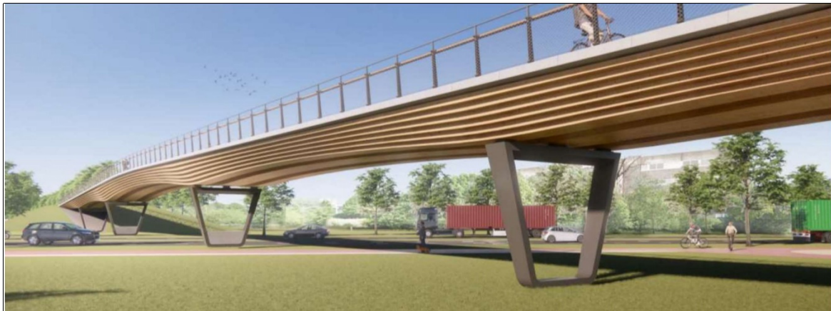
Abb. 7: Beispiel Blockträgerbrücke (Ingenieurbüro Miebach)
