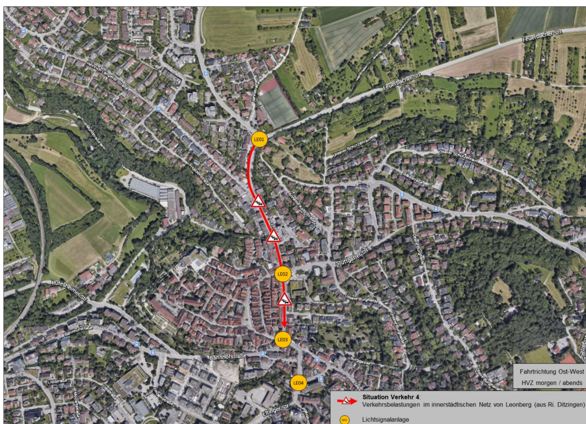
Abbildung 04: Überlastung auf der Feuerbacher Straße und/oder Grabenstraße stadteinwärts
