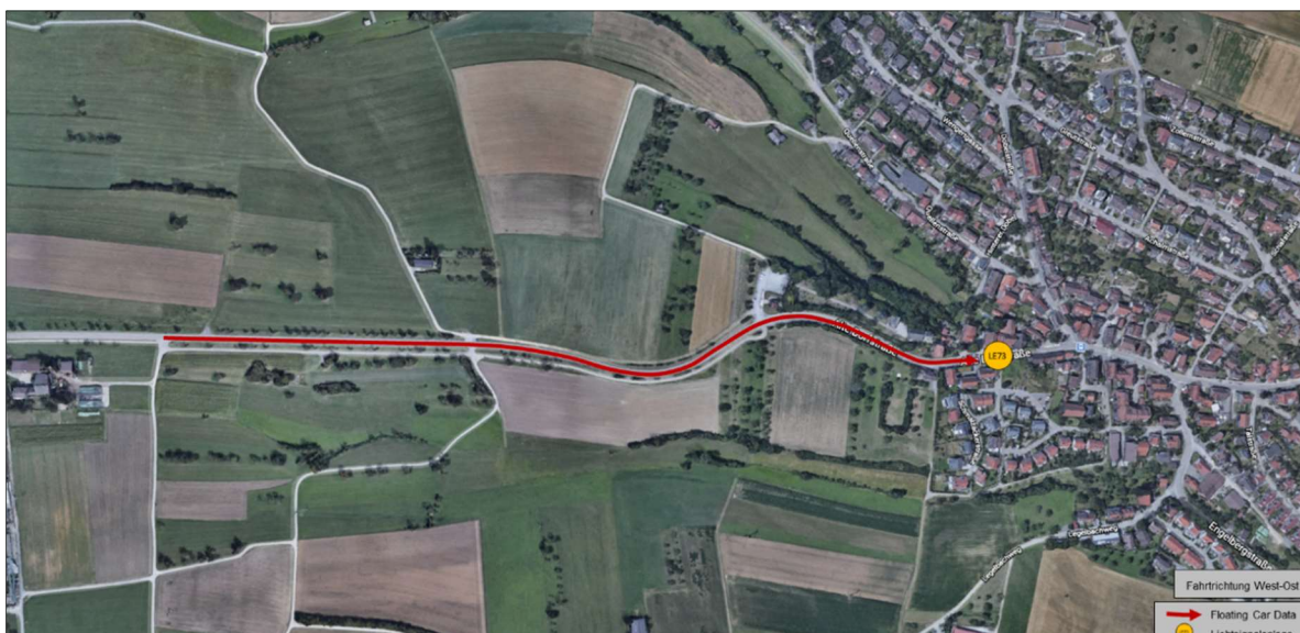
Abbildung 13: Detektion des Rückstaubereichs in der Zufahrt zu Gebersheim auf K 1059 durch Floating Car Data
