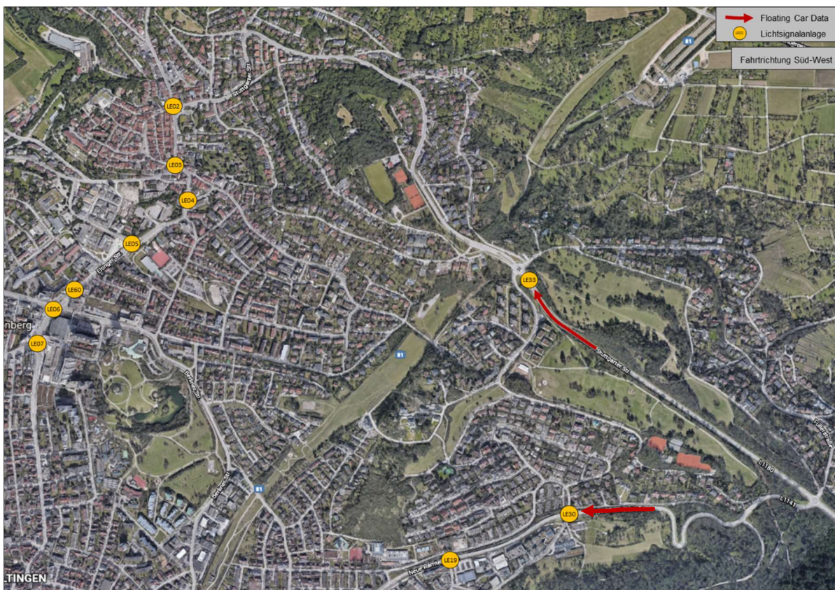
Abbildung 16: Detektion des Rückstaubereichs in der Zufahrt zu Leonberg auf L 1180 und Neue Ramtelstraße durch Floating Car Data
