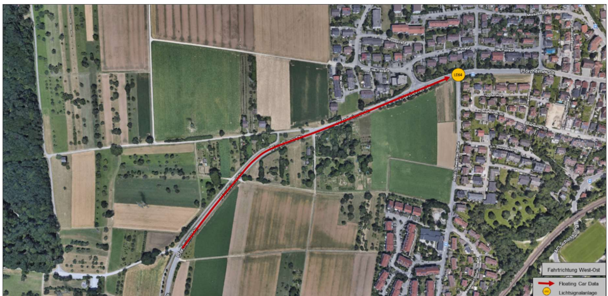
Abbildung 09: Detektion des Rückstaubereichs in Höfingen West durch Floating Car Data
