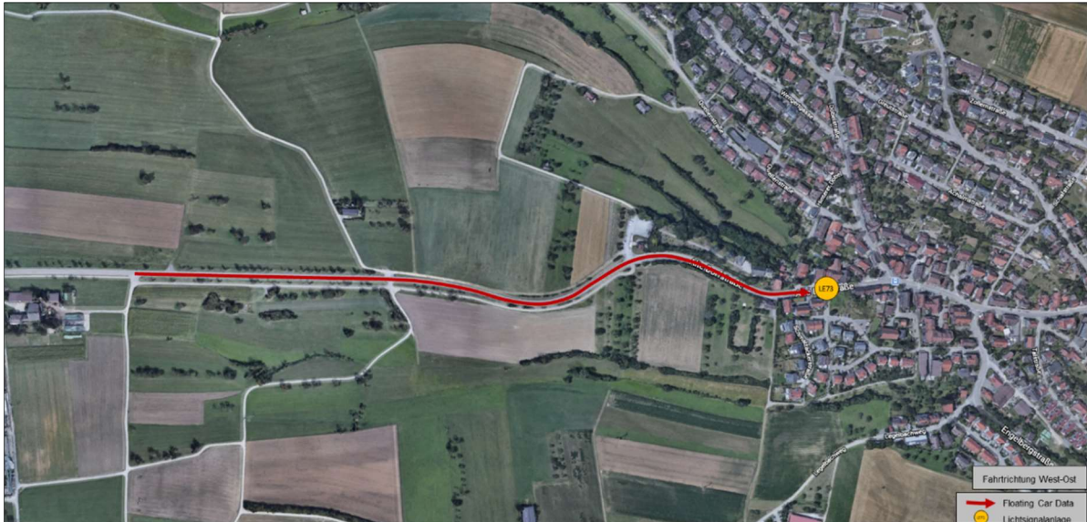
Abbildung 13: Detektion des Rückstaubereichs in der Zufahrt zu Gebersheim auf K 1059 durch Floating Car Data
