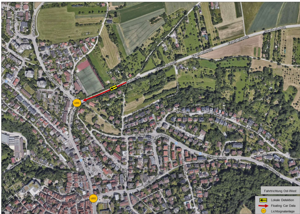
Abbildung 05: Detektion des Rückstaubereichs in der Zufahrt zu Leonberg auf L 1137 durch lokale Detektion und Floating Car Data
