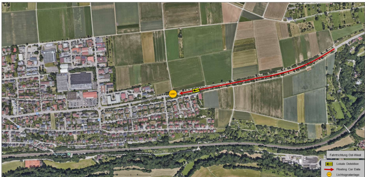
Abbildung 08: Detektion des Rückstaubereichs in Höfingen Ost durch lokale Detektion und Floating Car Data
